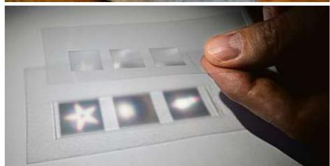
**Nanočočky** umožňují vytvořit tenká svítidla, která například umí většinu světla směrovat na zed, přestože jsou k ní kolmo. Jde to díky tenké fólii, která může mit desetitisíce čoček v jednom centimetru čtverečním. Jedno takové svítidlo předvádí Martin Jotov na snímku vlevo. Upravo nahore je vitézny hologram „Brouk a květina“ a dole je snímek prosvícené fólie s různě směrovanými nanočočkami. Foto: 3x Michal Šula, MAFRA
